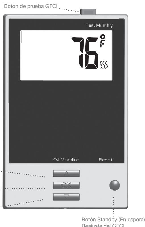
Espere 10 segundos para permitir que el termostato se acomode al nuevo punto de ajuste. Despu s pulse el bot n **TEST** (Prueba) en la parte superior del termostato. La prueba tiene éxito si se ilumina la luz roja en el bot n **TEST** y en la pantalla aparece **GROUND FAULT** (Fallo a tierra). Si esto no ocurre, verifique la instalaci n o comun quese con un electricista. Pulse el bot n **Standby/Reset** (En espera/reajuste) para reajustar el GFCI.
